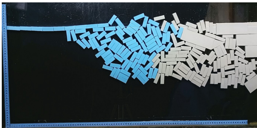
Рис. 10. Формирование кия согласно второму сценарию, когда наслонения и последующих завихрений не происходит, а новые блоки концентрируются у края кия тороса Fig. 10. Formation of the ice ridge keel according to the second scenario when the rafting and following eddying do not happen but new ice blocks are accumulated at the edge of hummock keel
