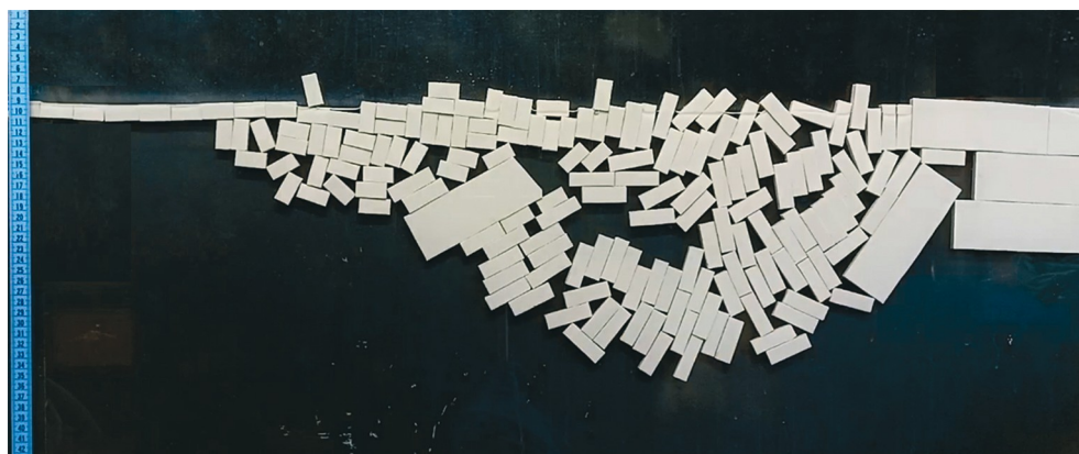
Рис. 6. Модельный профиль тороса, показывающий наличие протяжённых субгоризонтальных полостей в центральной части кия
