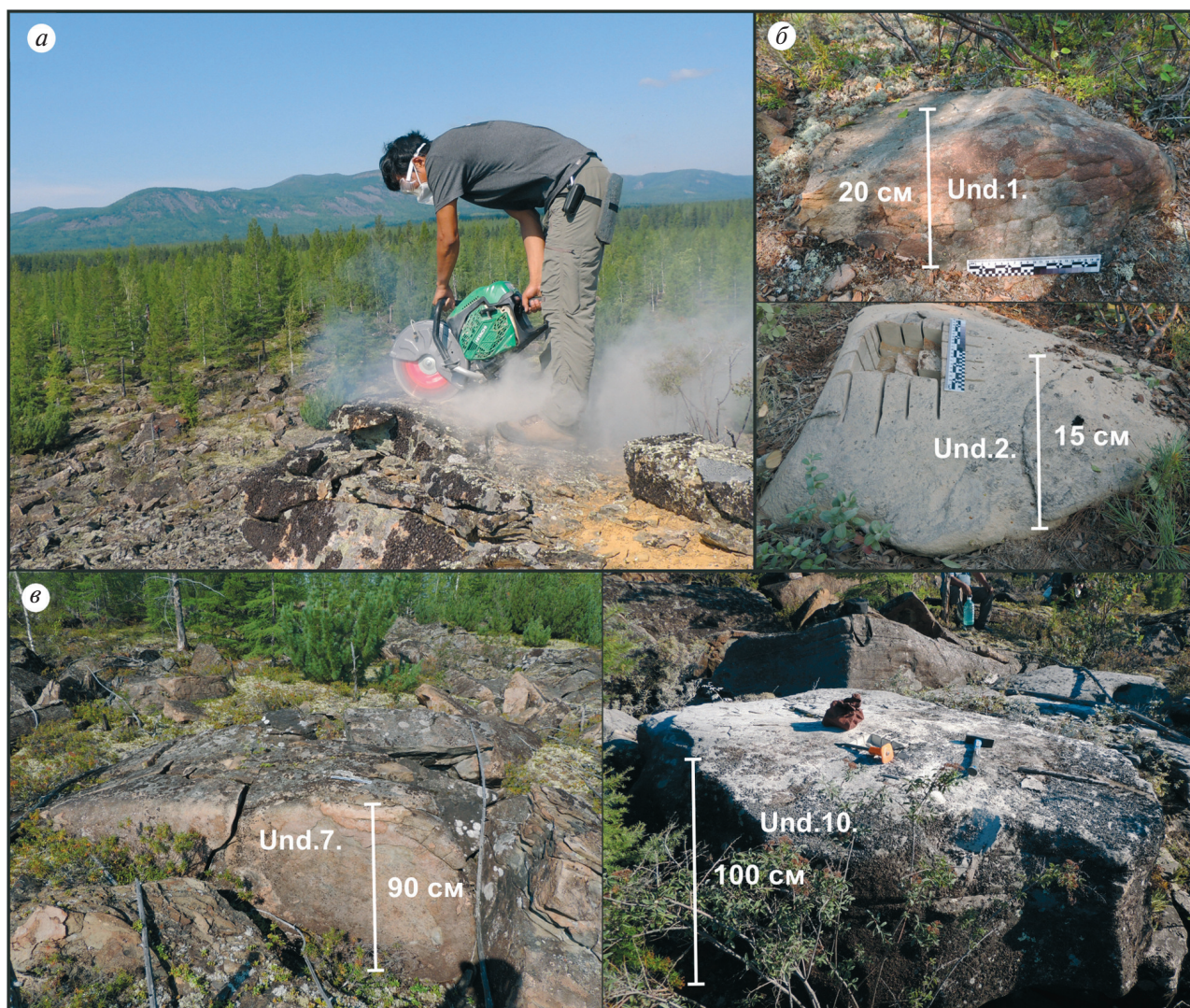
Рис. 2. Процесс отбора валунов циркулярной пилы (на фото В.М. Лыткин) (а); примеры валунов и коренных пород, отобранных для ^{10}\text{Be} датирования поверхностей экспонирования в долине р. Ундюлюнг (б–г)
