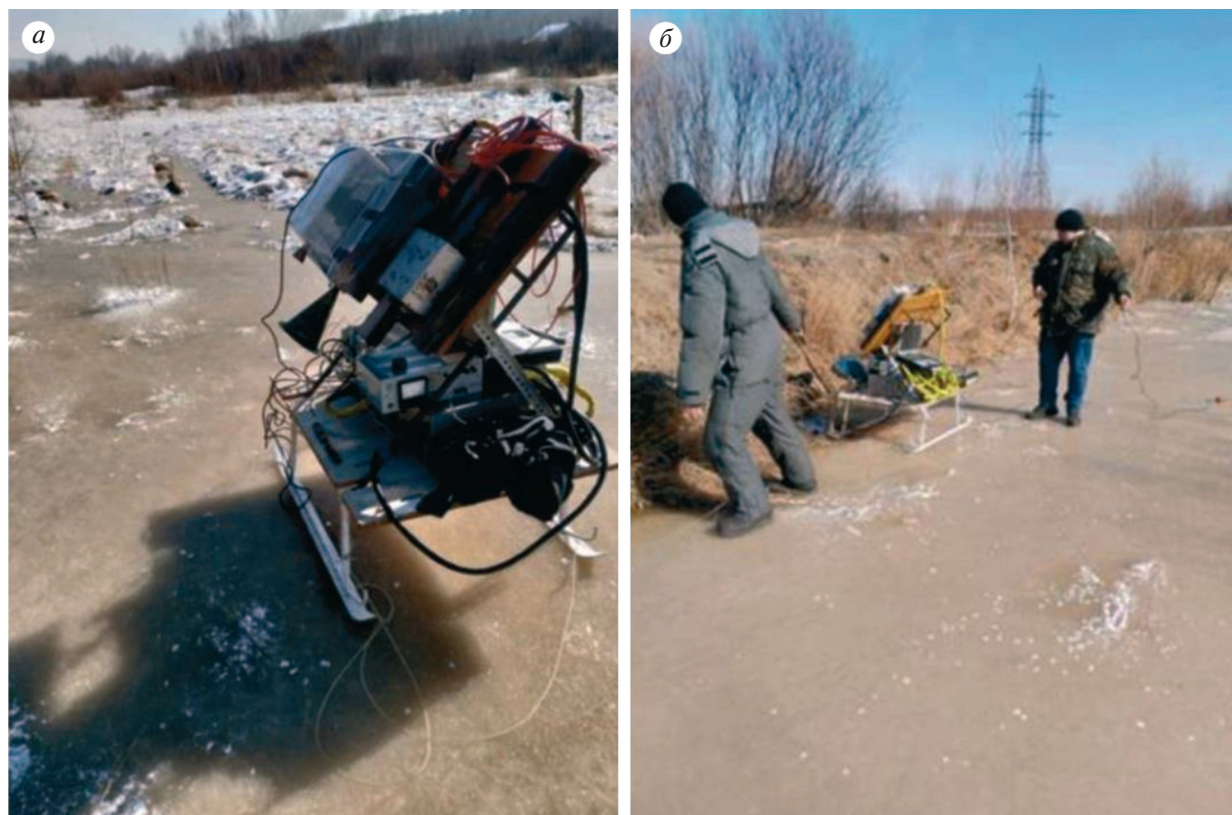
Рис. 2. Фотографии радиометрического комплекса, установленного на сани, для исследования излучательных характеристик наледи (а) и момент их измерений (б). Фото А.А. Гурулева, 6 марта 2025 г.
