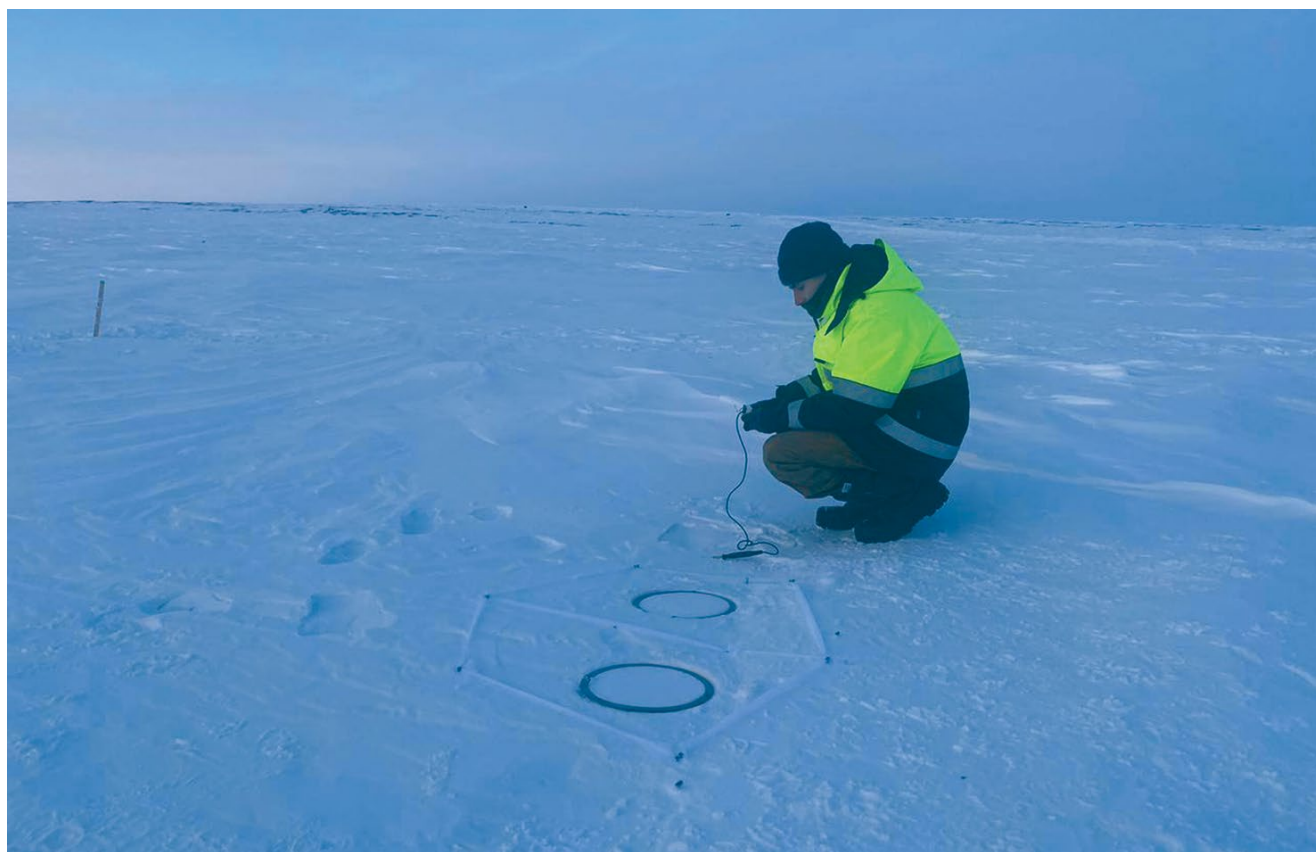
Рис. 1. Снегоиспарительная площадка с установленными на ней испарителями ГГИ-500-6. Процесс измерения температуры поверхности снежного покрова
