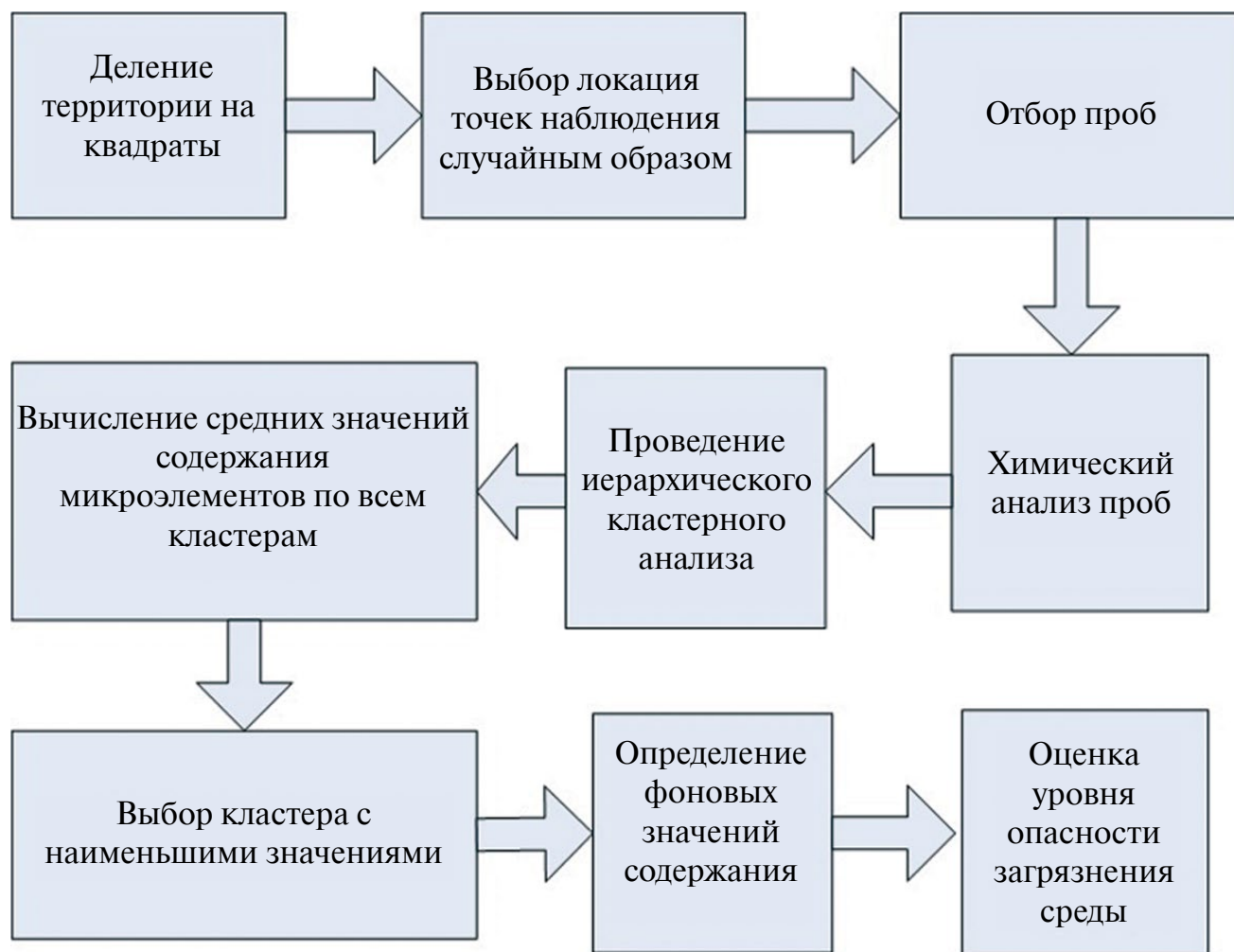
Рис. 2. Схема последовательности действий для выбора фоновых наблюдений и оценки уровня опасности загрязнения среды
