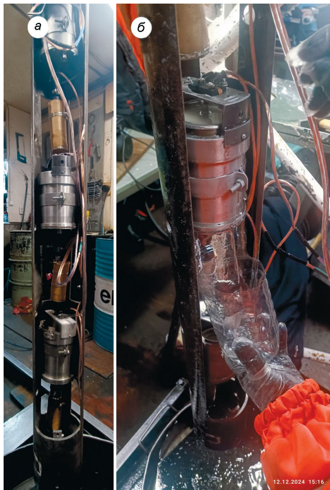
Рис. 2. Отбор проб заливочной жидкости: а — многосекционный пробоотборник с пробами заливочной жидкости, б — слив заливочной жидкости со второй секции пробоотборника
