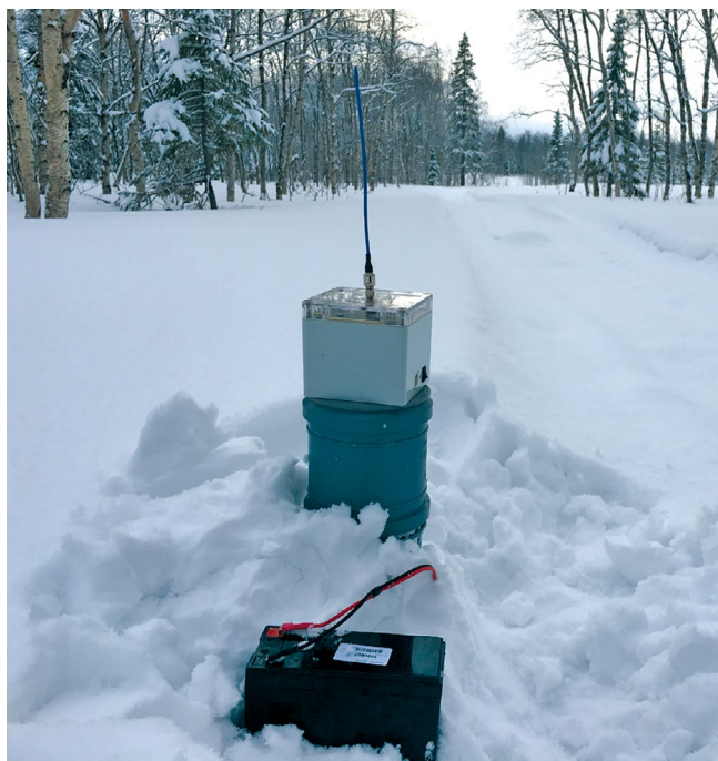
Рис. 1. Беспроводная станция на инфразвуковых микрофонах МР-201. Один из трёх регистрирующих модулей с аккумуляторной батареей. Фото А.И. Воронина, 19.03.2019
