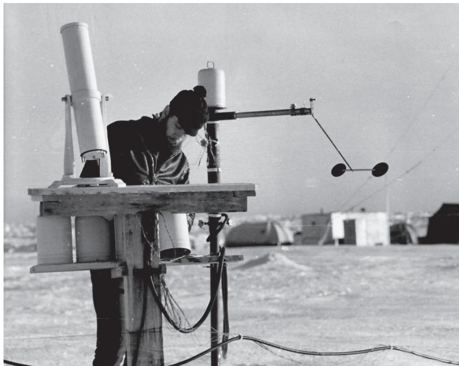
**Рис. 5.** Измерения спектральной плотности атмосферы на СП-22. Апрель 1974 г. Фото Н. М. Шестакова.
