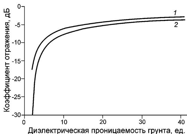
Fig. 4. Зависимость коэффициента отражения по мощности R_{1,2} от границы сухой снег–сухой и влажный грунт от относительной диэлектрической проницаемости (ОДП) грунта при плотности снега, \text{кг/м}^3 : 1 – 100; 2 – 400. ОДП сухого грунта изменяется в диапазоне от 2 до 6, а для влажного грунта – от 5 до 40 (см. табл. 2)
