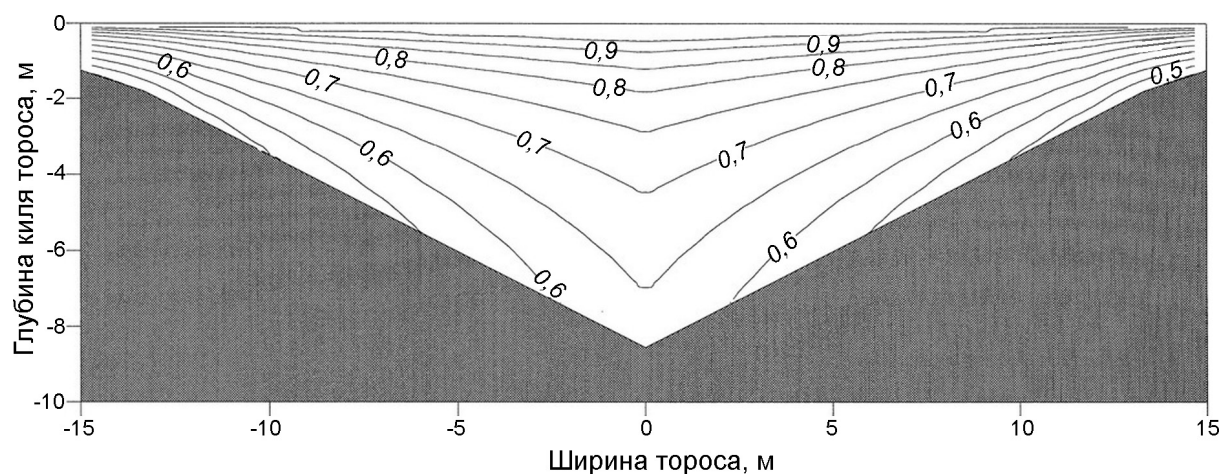
Рис. 2. Пример пространственного распределения заполнения для киля тороса
