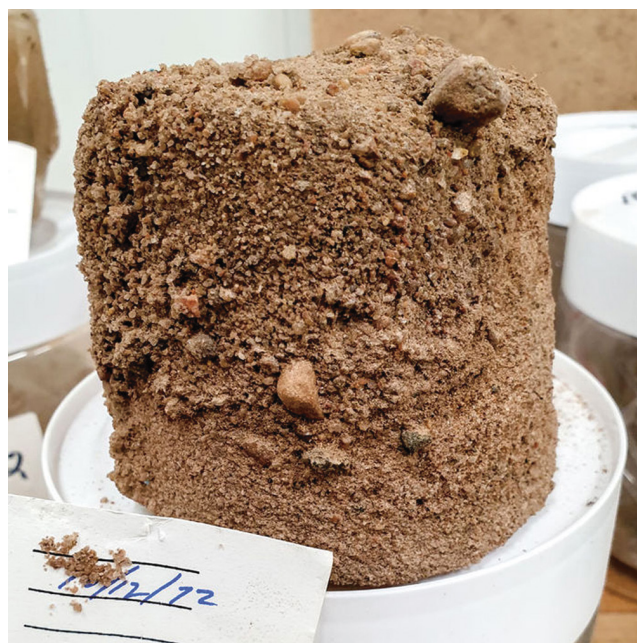
Рис. 9. Образец мелкозёма из нижней части керна льда Camp Century [9]
