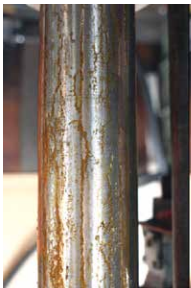
Рис. 3. Буровая коронка со следами ржавчины после вскрытия озера
