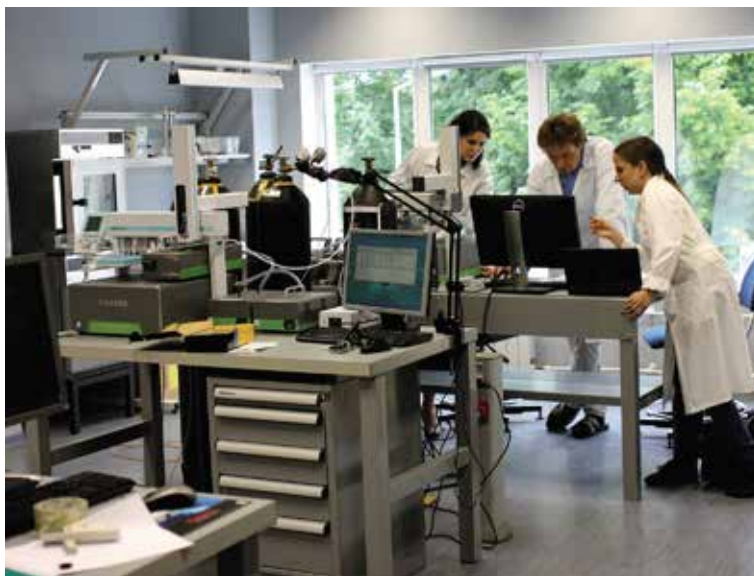
Рис. 1. Приборное оснащение ЛИКОС ААНИИ обеспечивает отличное качество и высокую производительность изотопных исследований, позволяет анализировать до 170 образцов в день на содержание дейтерия и ^{18}\text{O} и до двух образцов в день, если необходимо дополнительно измерить концентрацию ^{17}\text{O}
