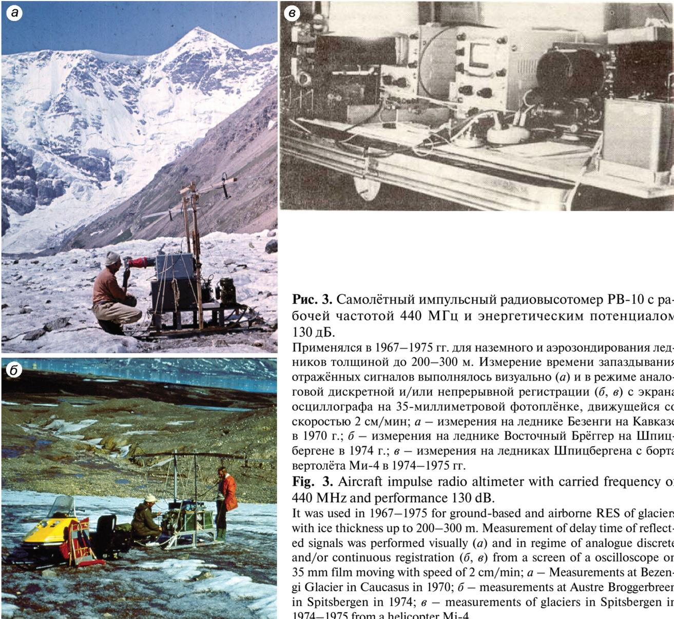
**Рис. 3.** Самолётный импульсный радиовысотомер РВ-10 с рабочей частотой 440 МГц и энергетическим потенциалом 130 дБ.
