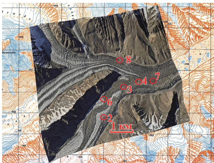
Рис. 3. Результат трансформирования перспективного космического снимка средней части ледника Бивачного, полученного с Международной космической станции 4 июля 2013 г., и наложения его на топографическую карту масштаба 1 : 50 000
