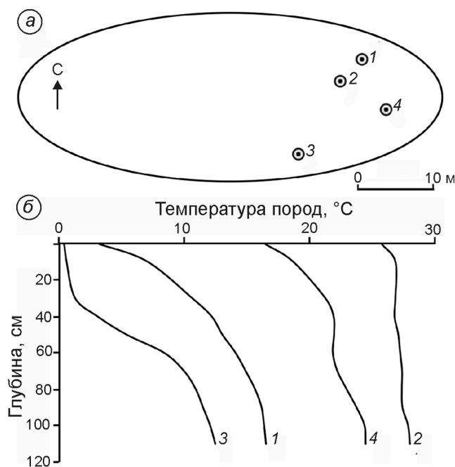
**Рис. 7.** Температурный режим пород в различных частях фумарольного поля на западном борту кратера Восточной вершины Эльбруса.
