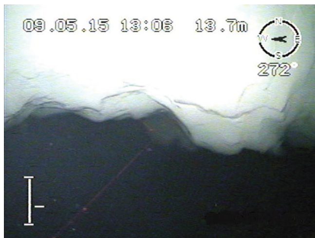
Рис. 5. Видеосъёмка кия старого тороса с помощью телеуправляемого подводного аппарата «Гном».
