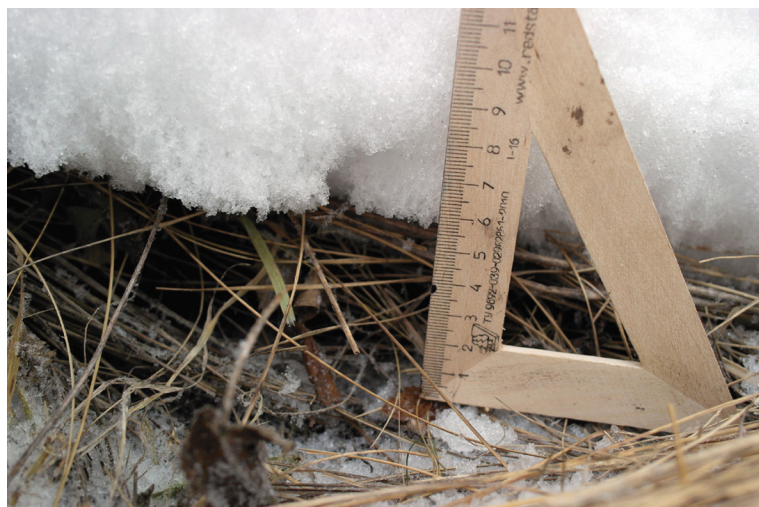
Рис. 1. Шурф № 2 в степи, с пятисантиметровым воздушным зазором на границе снег–почва (в поле озимых такой зазор отсутствует)
