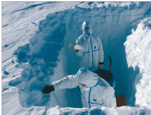
Рис. 1. Сбор поверхностного снега из шурфа глубиной 3 м в районе станции Восток
