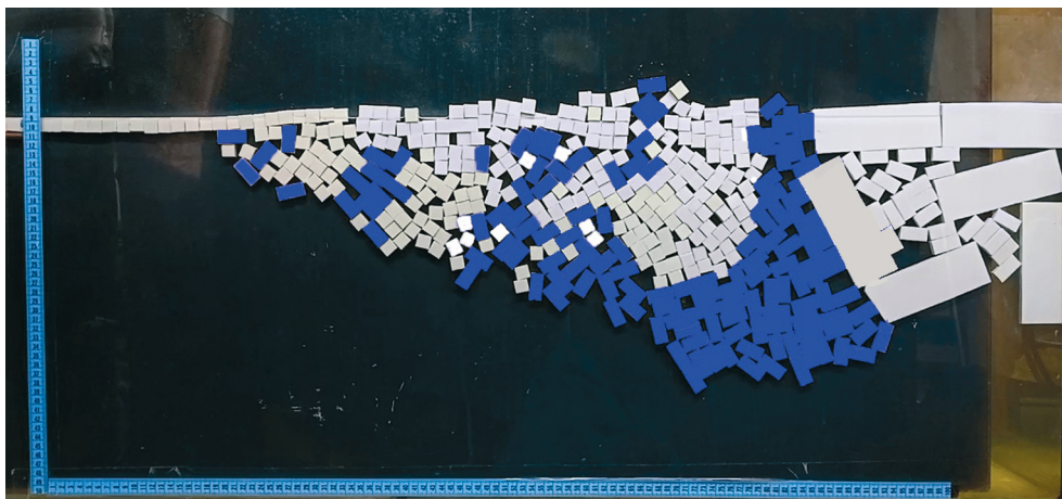
Рис. 8. Зоны внедрения блоков с размером 1.5 \times 1.5 см в торос, сформированный блоками 3 \times 1.5 см на краю толстого льда Fig. 8. Zones of embedding blocks with a size of 1.5 \times 1.5 cm into a hummock formed by blocks of 3 \times 1.5 cm on the edge of thick ice
