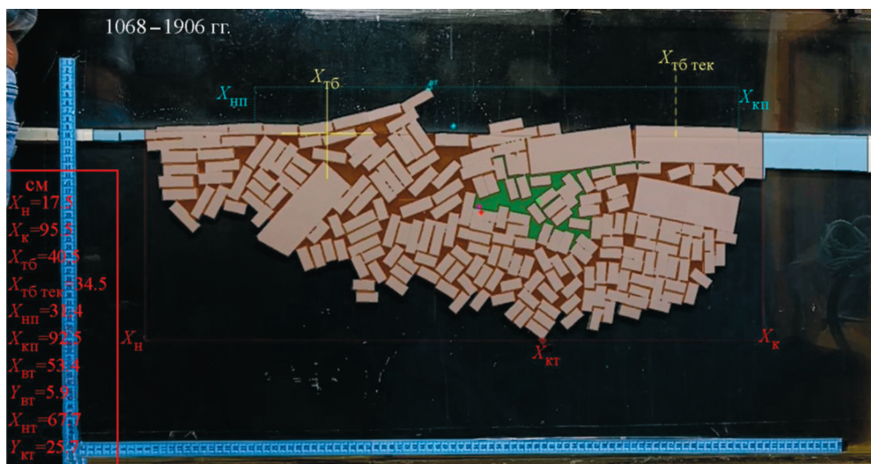
Рис. 2. Обработанное изображение 1906-го кадра, приведённое в качестве примера. В результате обработки фиксируется двадцать морфометрических параметров внутреннего строения модельного тороса. Голубым цветом обозначен ровный лёд, бледно-розовым – блоки в торосе
