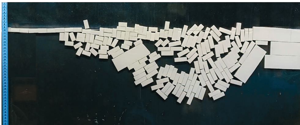
Рис. 6. Модельный профиль тороса, показывающий наличие протяжённых субгоризонтальных полостей в центральной части киля Fig. 6. A model profile of a hummock showing the presence of extended horizontal cavities in the central part of the keel
