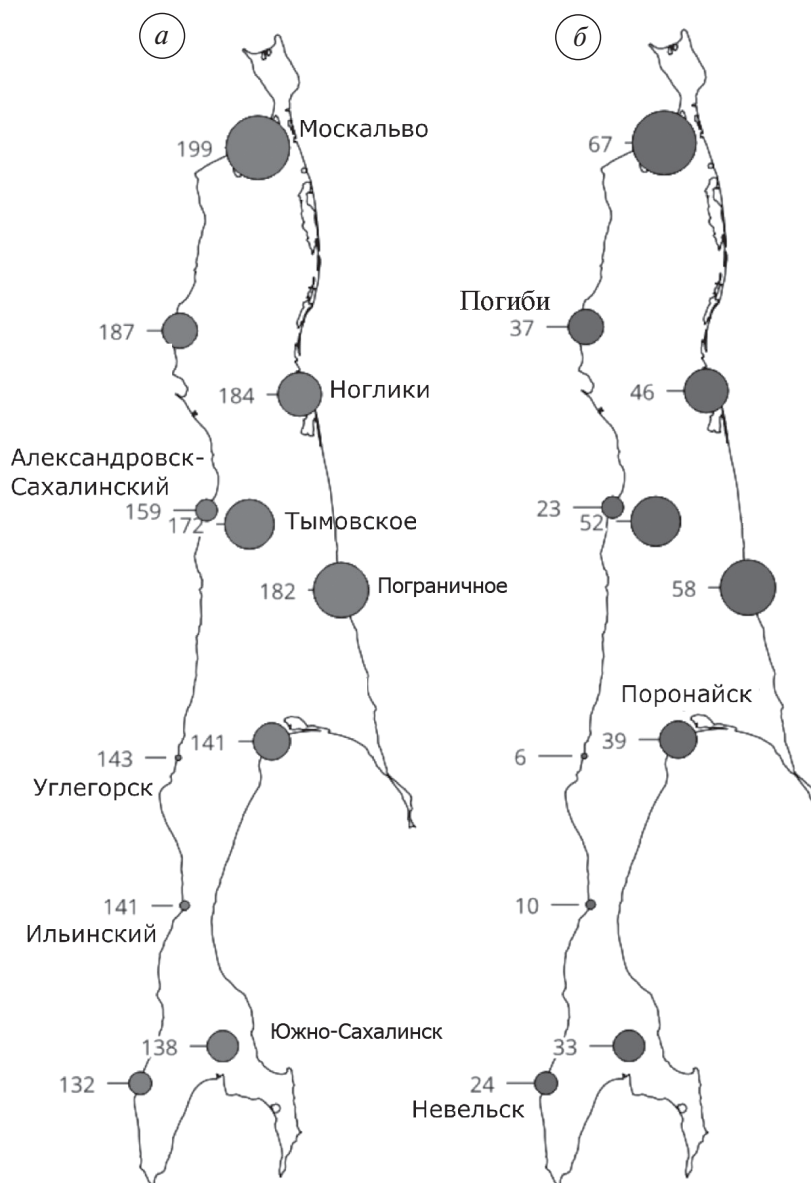
Рис. 3. Среднемноголетние значения параметров снежности зим на Сахалине: средняя продолжительность залегания устойчивого снежного покрова, сутки (а); среднемноголетняя среднезимняя толщина снежного покрова, см (б)
