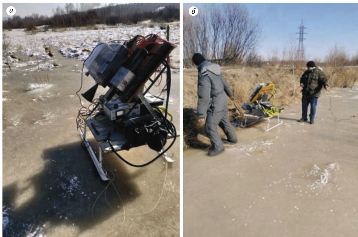
Рис. 2. Фотографии радиометрического комплекса, установленного на сани, для исследования излучательных характеристик наледи (а) и момент их измерений (б). Фото А.А. Гуралева, 6 марта 2025 г.
