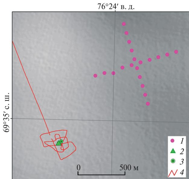
**Рис. 2.** Схема профилей радиолокационного зондирования и положение снегомерного полигона в районе буровой скважины на «Аномалии»: 1 – снегомерные вехи; 2 – буровая; 3 – кернохранилище; 4 – профили радиолокационного зондирования
