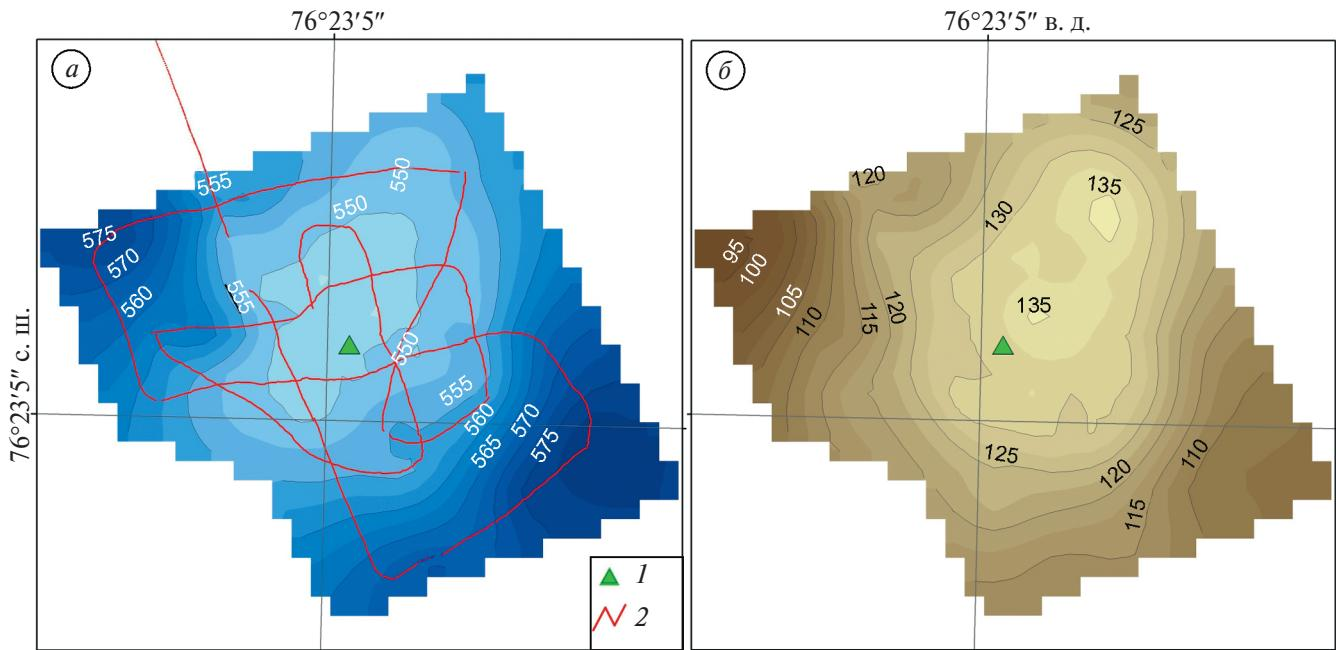
**Рис. 3.** Схема распределения толщины льда (*а*) и рельефа подледного ложа (*б*) в районе скважины: 1 – положение скважины; 2 – профили радиолокационного зондирования
