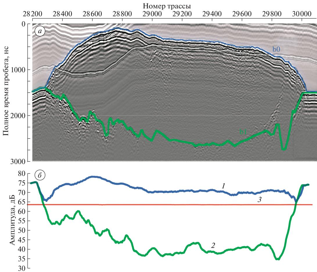
**Рис. 1.** Пример радарной записи 035\_014\_10 с отпикованными отражениями от поверхности (b0) и ложа (b1) ледника (a) и осредненные по 50 трассам амплитуды этих отражений (б) от поверхности (1) и ложа (2). Линия (3) показывает амплитуду зондирующего импульса.
