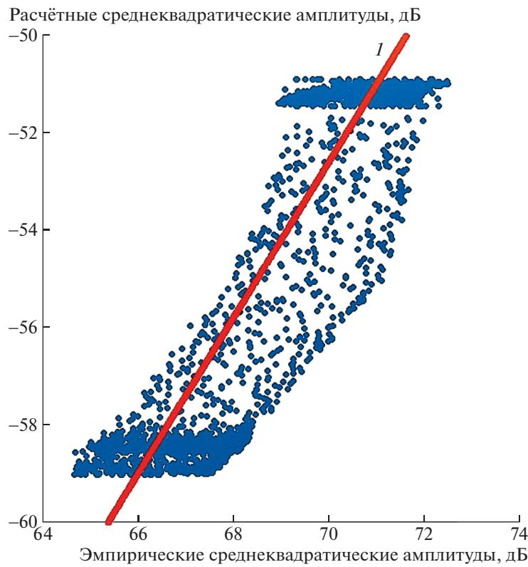
**Рис. 3.** Калибровка измеренных значений отраженных сигналов. По горизонтальной оси эмпирические среднеквадратические амплитуды отражений от поверхности моря, дБ; по вертикальной оси её рассчитанные значения с учётом геометрической поправки за высоту полета и постоянного коэффициента отражения по мощности от морской воды, дБ. (1) – калибровочная линия.
