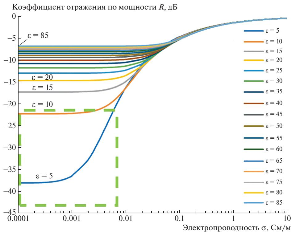
**Рис. 4.** Коэффициент отражения по мощности ( $R$ , дБ) на частоте 20 МГц как функция электропроводности ( $\sigma$ , См/м) и относительной диэлектрической проницаемости материала ( $\epsilon$ ), находящегося подо льдом. Кривые построены для значений относительной проницаемости материала от 5 до 85 (с шагом 5). Для льда принята относительная проницаемость 3.19 и электропроводность  $10^{-5}$  См/м. Зеленым пунктиром выделена область значений коэффициента отражений на ложе купола Вавилова.
