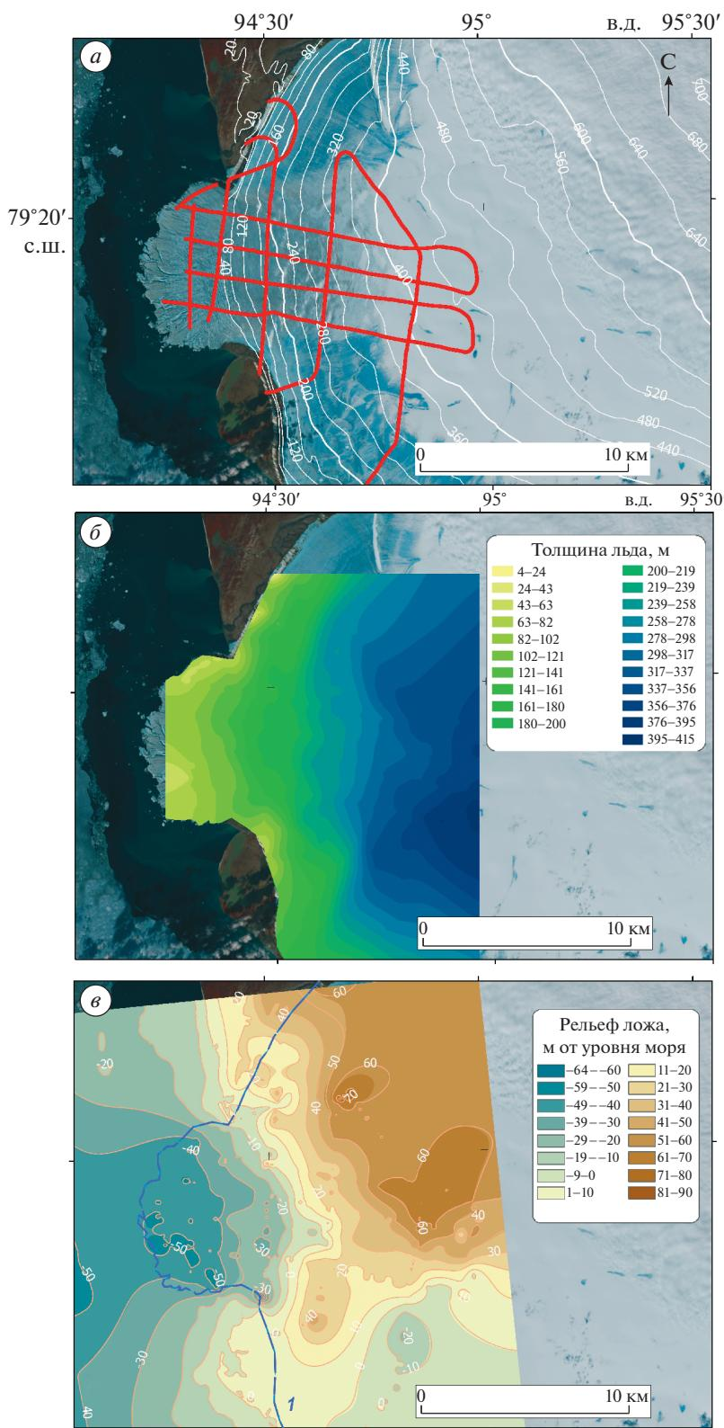
**Рис. 2.** Положение профилей аэрорадиозондирования в западной части ледникового купола Вавилова (а), картосхемы толщины льда (б) и подледного рельефа (в) по этим данным. Для карты подледного рельефа использовались также данные батиметрии у фронта ледника. Линия (1) показывает положение края ледникового купола в августе 2014 г.
