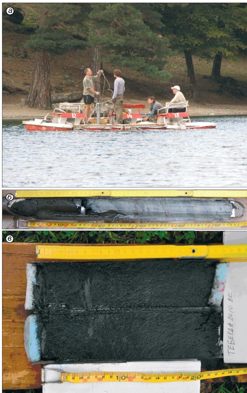
**Рис. 3.** Бурение озёрных осадков оз. Каракель:
