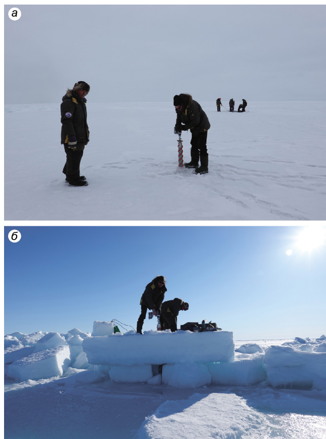
Рис. 1. Процесс отбора керна:
