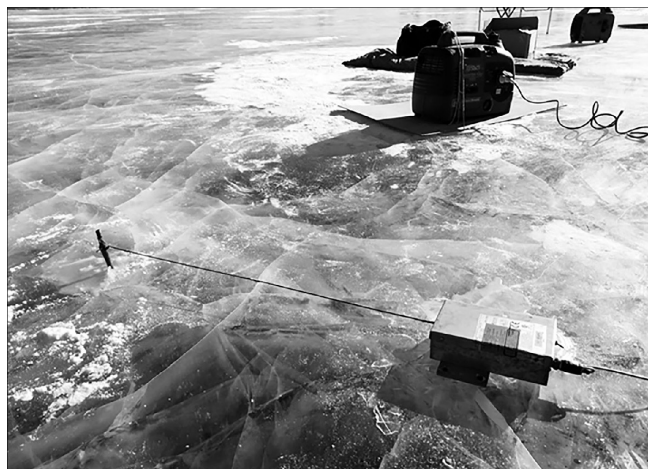
Рис. 3. Фотография датчика деформации, установленного на ледяном покрове оз. Арахлей
