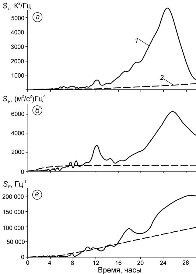
**Рис. 4.** Значения функций спектральной плотности (дисперсия анализируемой метеорологической величины, делённая на частоту её колебаний, выраженную в минутах), рассчитанные по данным измерений на Западном плато (1), по сравнению со спектральной функцией «красного шума» (2), характеризующей случайный процесс:
