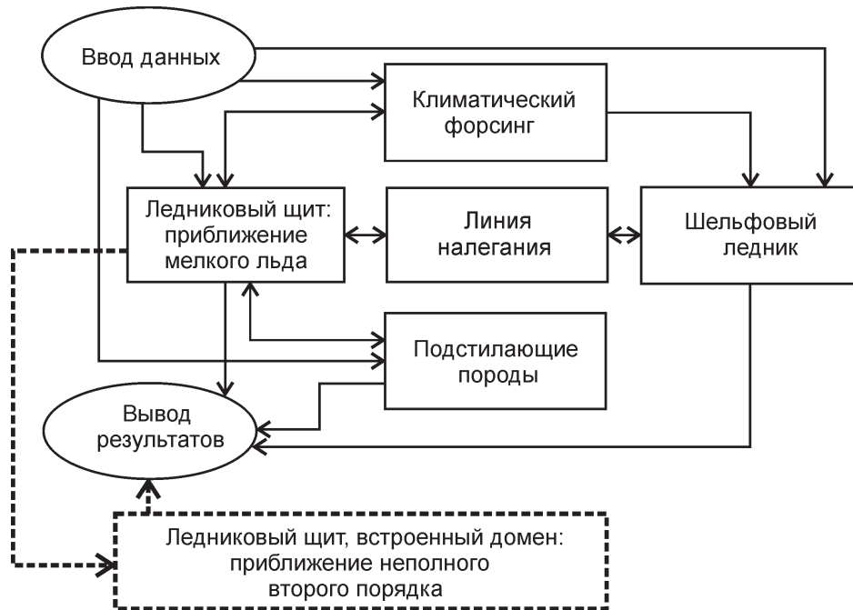
Рис. 2. Основные блоки в региональной модели и организация взаимодействия между ними Fig. 2. Main blocks of the nested model and interaction between them
