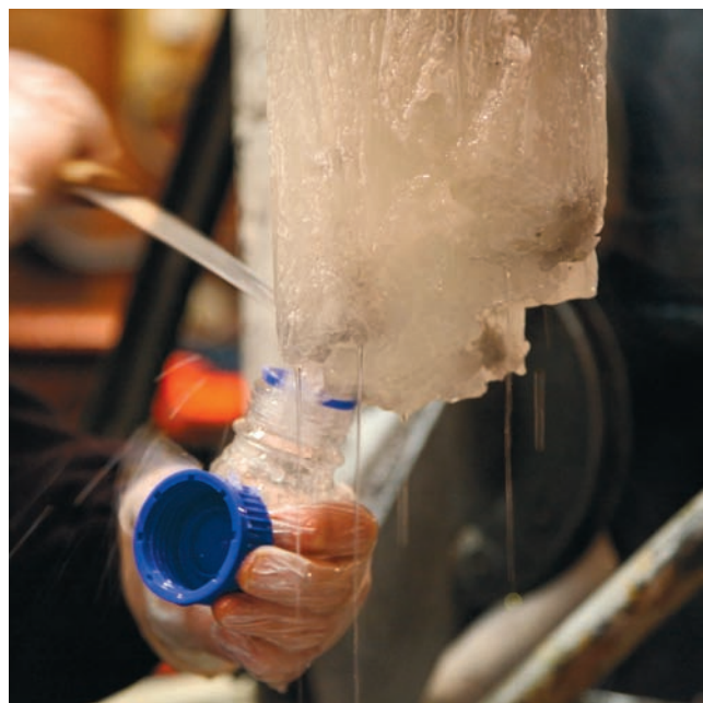
Рис. 3. Отбор пробы озерной воды, замёрзшей на коронке бурового снаряда во время его подъёма на поверхность после вскрытия оз. Восток
